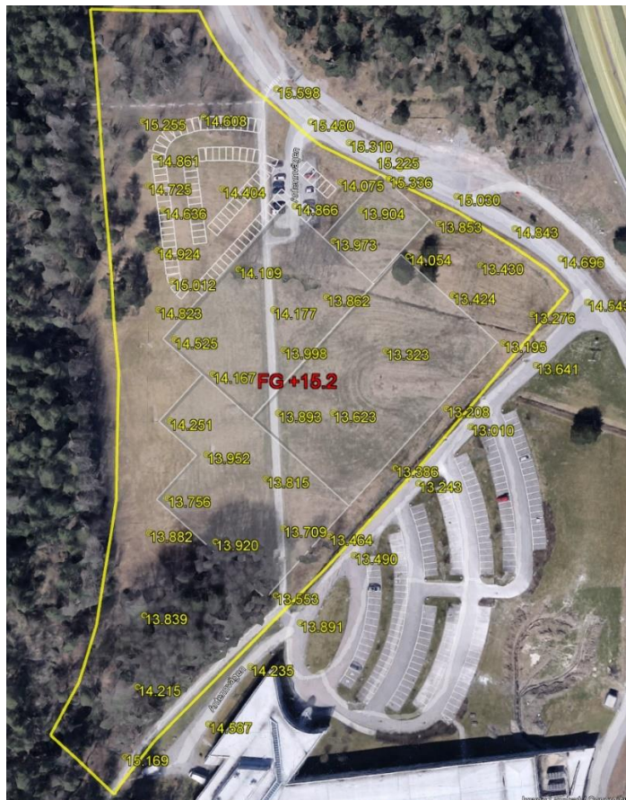
Figur 5. Befintliga marknivåer enligt laserskanningsdata (Lantmäteriet).
